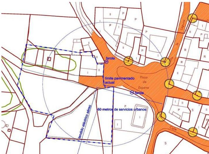
En estos dos esquemas se muestra de forma sintética el nivel de urbanización, junto con el señalamiento de un círculo de 50 m. dentro del cual es posible la clasificación de forma reglamentaria.
